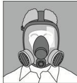
(D) Full-face, particulate filter (cartridge) respirator
